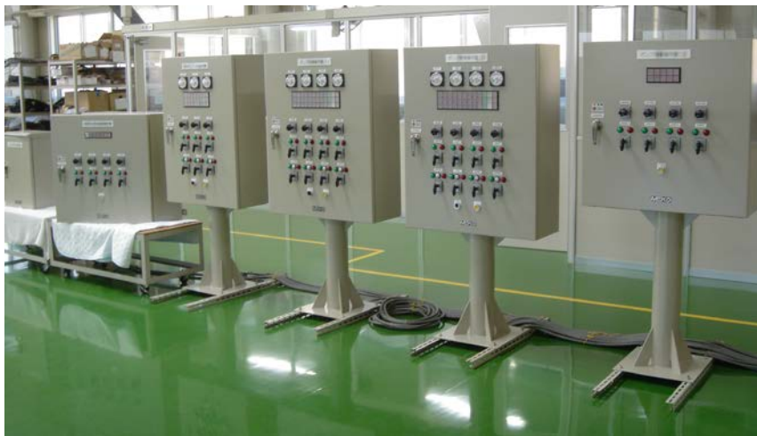
現場操作盤（スタンド盤）
